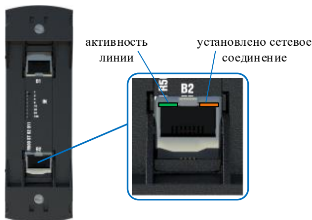
Рисунок 45 - Индикация интерфейса RJ45 модулей ST XX 0XX
